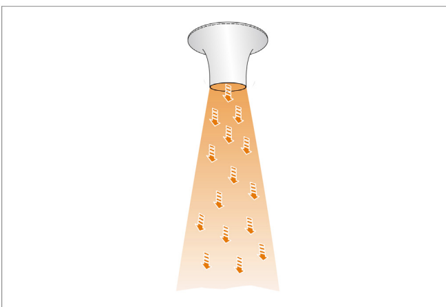
Vzorec zraka šobe DUK-F z vertikalnim dovajanjem, način ogrevanja
