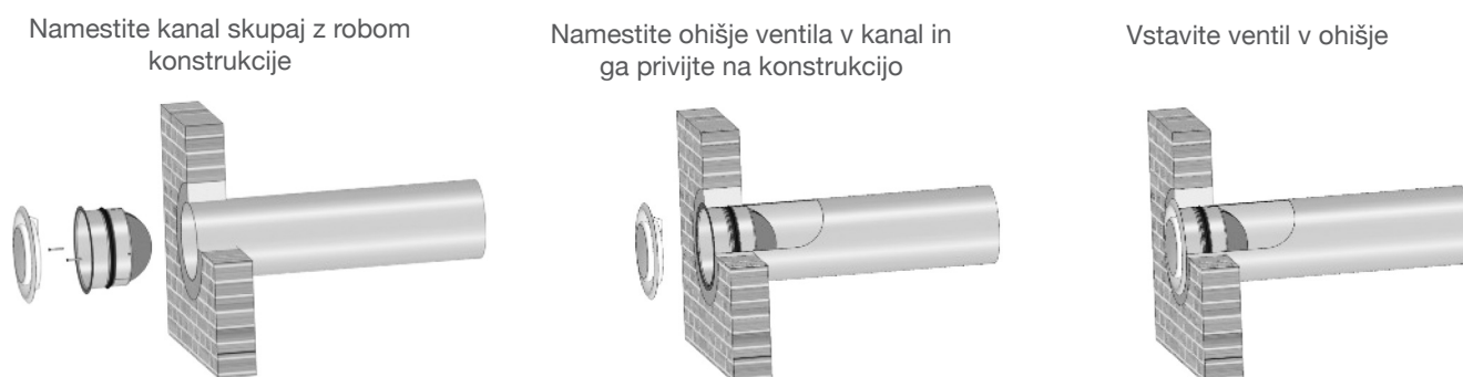
Slika 10: Vgradnja lopute CFDM s krožnikastim ventilom v mavčno stensko konstrukcijo
