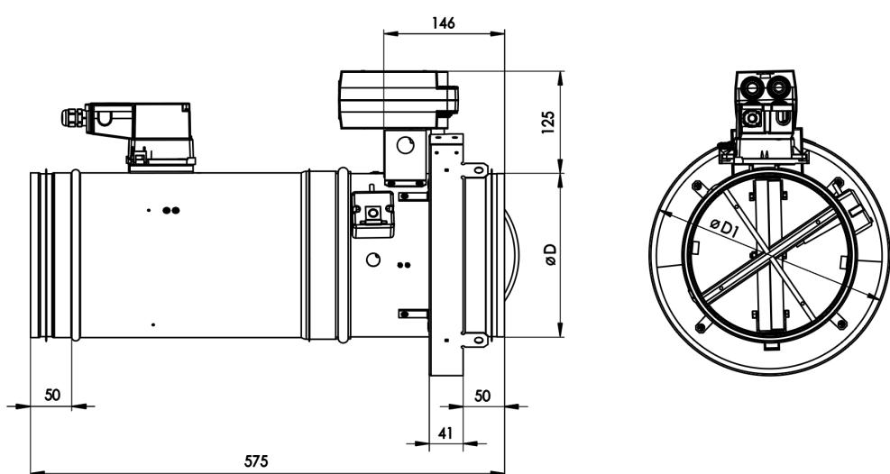
**Prekrivanje usmernika – loputa FDMS-VAV s sprožilnim mehanizmom**
